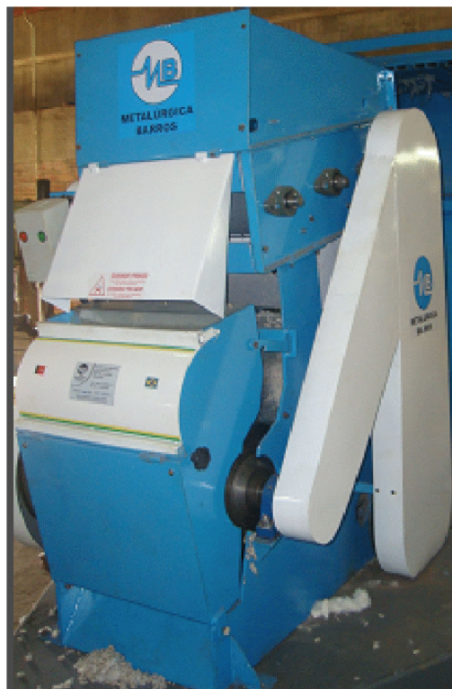
Figura 2. Limpador e descaroçador de 25 serras
